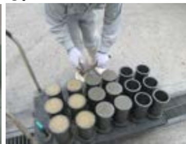
その6 最後に試験体を作成し、後に養生期間に応じた圧縮強度試験を行い、どの程度の圧力まで破壊されることなく強度を維持できるかのテストを行う。
